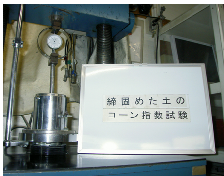
締固めた土のコーン指数試験 建設発生土
